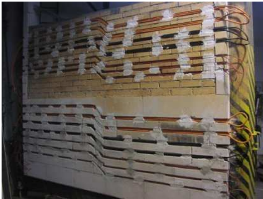
Obr.1 Uloženie káblov do konštrukcie stavby pod omietku (ukážka zo skúšky funkčnej odolnosti)
