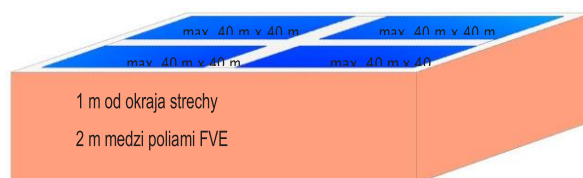
Obrázok 8 – Príklad štyroch poľí modulov na plochej streche bez prestupujúcich požiarnych stien s atikou
