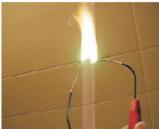
Obrázok A.1 – Elektrický oblúk v obvode 200 V DC
