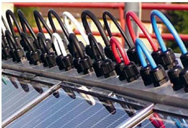
Obrázok A.20 – Skúšanie izolačných vlastností káblov z hľadiska vplyvu prostredia a polomeru ohybu
