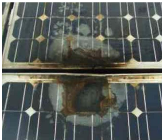
Obrázok A.12 – Účinky elektrického oblúka na prednú časť modulu
