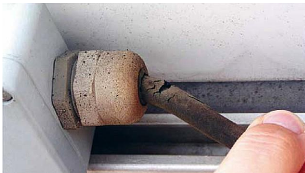
Obrázok A.21 – Závažný nedostatok pri skúške vplyvu ozónu na bežne používané káble typu H07RN-F
