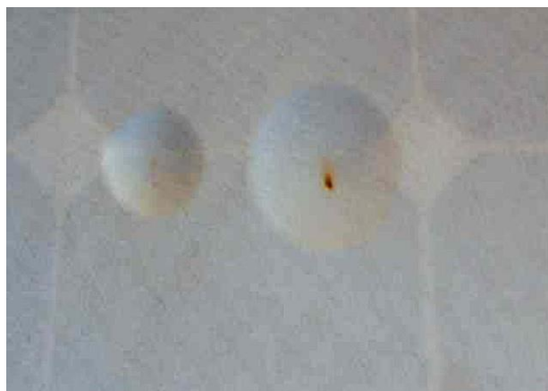
Obrázok A.8 – Účinky prehriatia viditeľné na povrchu spodnej strany modulu
