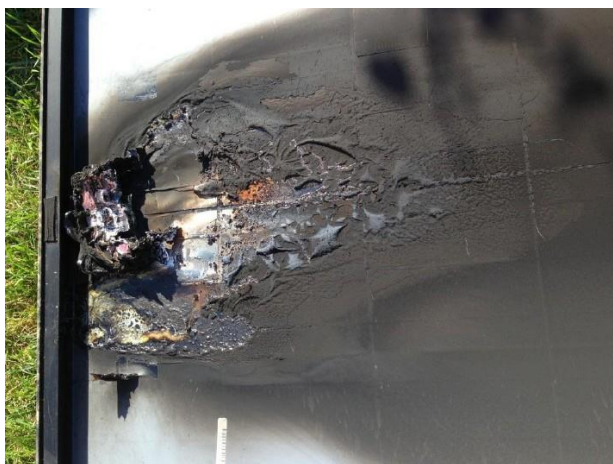
Obrázok A.11 – Účinky elektrického oblúka na zadnú stranu modulu
