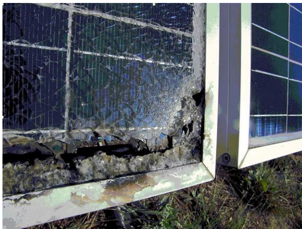
Obrázok A.4 – Účinky zemného elektrického oblúka cez kovový rám modulu
