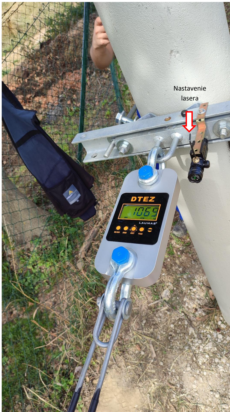
Obr. 19 Ciachovanie lasera na stĺpe „R“ (vytvorenie roviny medzi kotviacimi bodmi)
