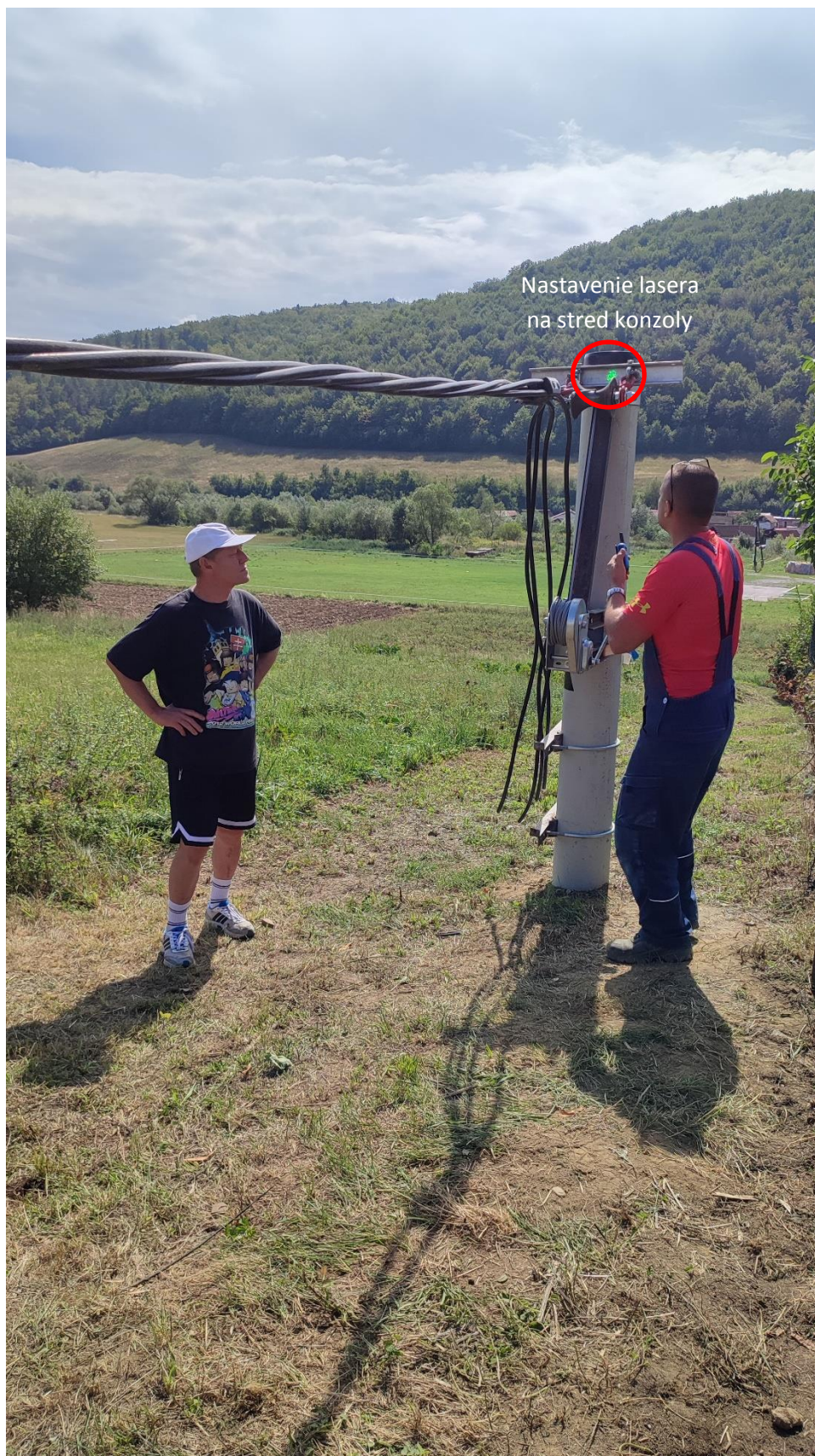
Obr. 20 Ciachovanie lasera na stĺpe „K“ (vytvorenie roviny medzi kotviacimi bodmi)
