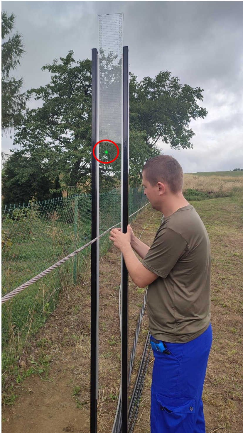
Obr. 21 Odčítanie hodnoty viditeľného priehybu na plexiskle
